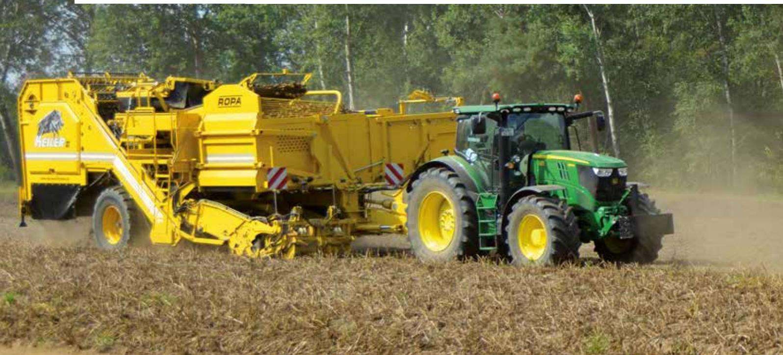
der Geschwindigkeit angepasst werden. Das gilt auch für die vier umlaufenden Fingerkämme und die Igelbänder dieses Roders.
