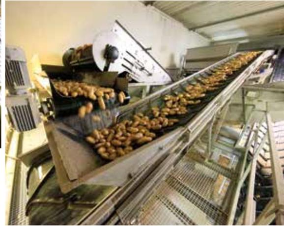
Vor Ort werden die Kartoffeln mit einer hydraulischen Ladevorrichtung vom Hänger geladen. Die moderne Aufbereitungs- und Waschanlage kann die Knollen nicht nur in verschiedenen Fraktionen sortieren, sondern auch nach ihrem spezifischen Gewicht aufbereiten. Ein Großteil der dort verarbeiteten Kartoffeln geht über einen Schwimmkanal direkt in die angrenzende Pommesfabrik Aviko – der andere Teil geht an zahlreiche Kunden im In- und Ausland.
