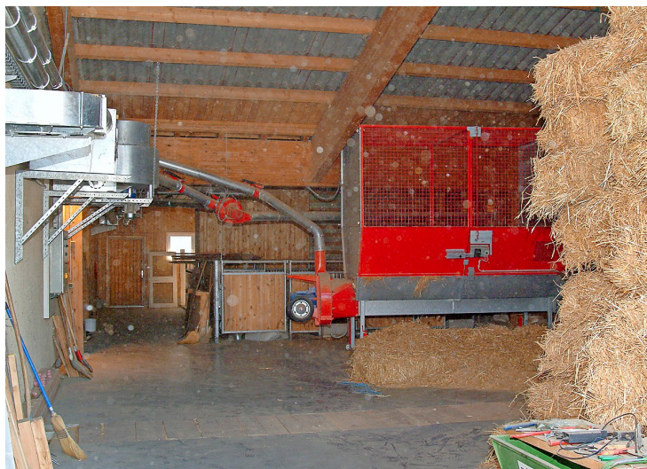
Mit einer stationären Einstreueinrichtung mit pneumatischem Verteilsystem können mehrere Verteilkreise von einem Vorratsbehälter aus versorgt werden.
