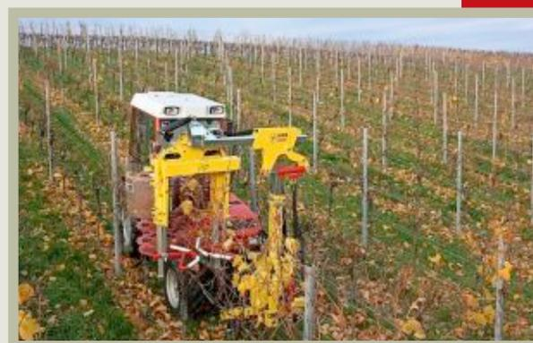
Viele Winzer wünschen sich eine bessere Mechanisierung der Rebschneidearbeiten. Eine Teilmechanisierung ist mithilfe von Rebvorschneidern und Entranker-Vorschneider-Kombinationen möglich. **Seiten 17–23**
