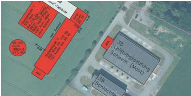
Abb. 1: Iden, ZTT der LLG, NEUBAU Schweinemaststall Variante 7 mit 600 Mast-, 80 Jungsau-, 120 Ferkelplätzen konventionell und Abluftreinigung, 150 Mastplätzen konventionell mit Außenklimareiz und 150 ökologische Mastplätzen mit Auslauf; ANBAU Abluftreinigungsanlage am vorhandenen Maststall; Stand: August 2020
